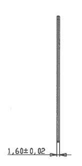
Klammerrohdraht: verzinkter runder Stahldraht ø 1,53±0,03mm Zugfestigkeit ≥ 900 N/mm² Harzung  $L_H =$  mind. 0,5  $L_n$ ;  $\geq$  20mm Zinkauflage  $\geq$  86 g/m<sup>2</sup> Schaftlänge  $L_n =$  25,0 - 100,0mm
